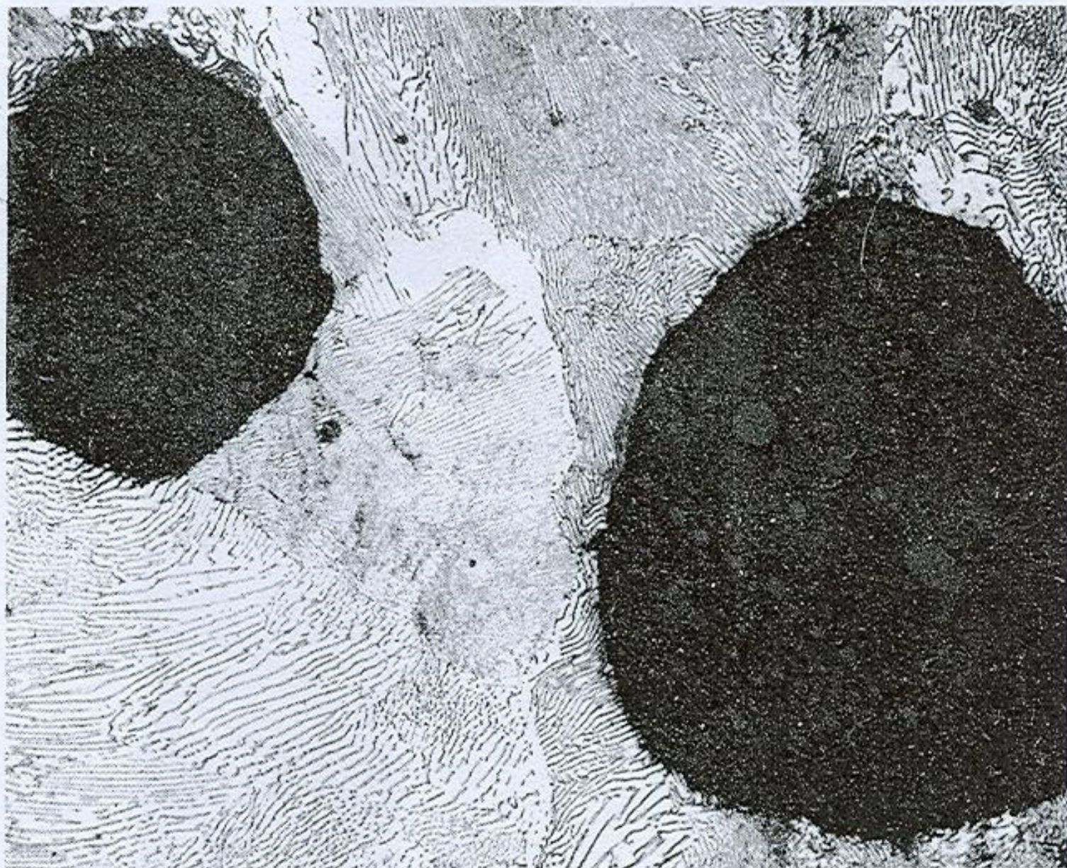
Fig. 11.20 Fundición nodular perlítica. Atacada con nital al 2 % \times 500 . ( The International Nickel Company. )
