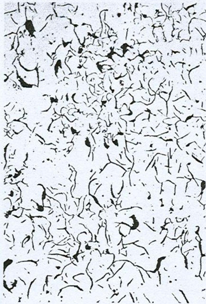
Fig. 11.12 Láminas de grafito en una fundición gris. Sin atacar, \times 100 .
