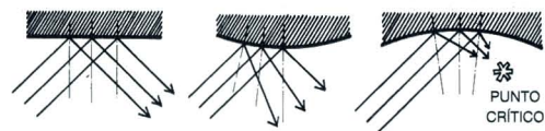
5.2. Diagrama en el que se muestra la reflexión de las ondas de sonido y cómo las superficies curvas dispersan o concentran el sonido reflejado.
