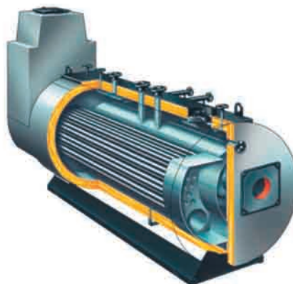
Figura 4.10. Caldera piro-tubular de vapor con economizador incorporado.
