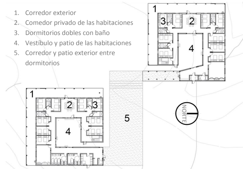
Planta del módulo dos del centro de retiro Won Dharma Modificado por DJ (2014)
