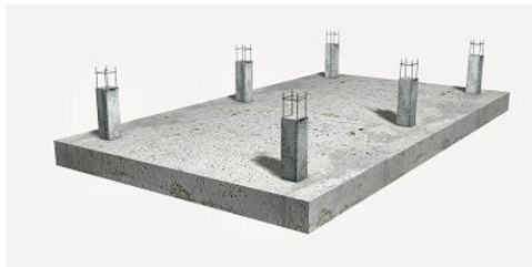
Losa de Cimentación (17) con columnas.
