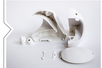
Fuente: Propia. 46 Producción de las piezas de plástico inyectado.
