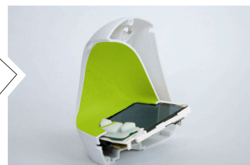
Fuente: Propia. 52 Ensamblaje de partes y glucómetro a la carcasa.
