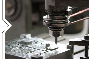
Fuente: http://www.globalspec.com 45 Mecanizado del molde de inyección.
