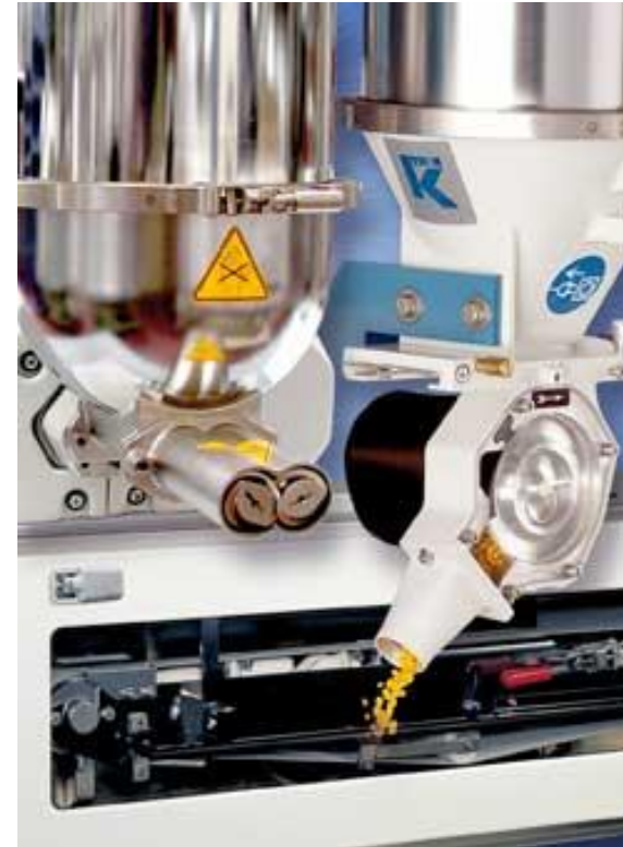
Imagen 1 Dosificador automático de polvos y granulados. Fuente http://www.ktron.es/process-equipment/feeders/technology/feeding-technology.cfm Dosificador de polvos.
