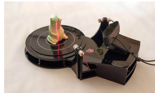
Escáner a base de láseres marca Rubicon 3D. En este escáner, el objeto gira en la plataforma para que la cámara y láseres detecten toda la forma y sus medidas.
