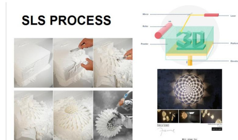
**Proceso y partes de una impresora SLS**
