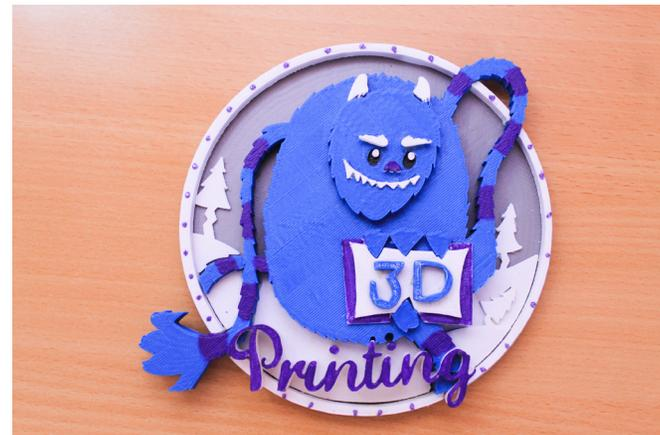
7. Finalmente, se pintó detalles con pintura acrílica, y pintura de tela para crear volúmenes y probar si el plástico PLA puede ser pintado con cualquier pintura.
