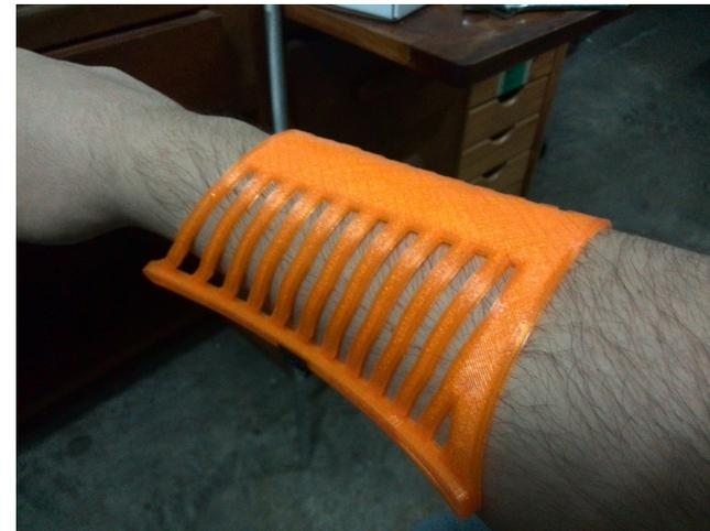
**Brazalete de armadura. Se imprimió en forma plana, luego se calentó y se moldeó a la forma del brazo de la persona.**
