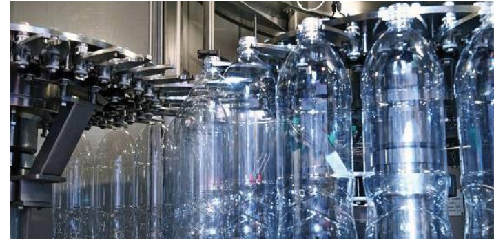
Figura 2. Soplado de envases PET Fuente: http://www.interempresas.net/Plastico/FeriaVirtual/Producto-17-botellas-por-segundo-el-Combi-mas-rapido-30365.html
