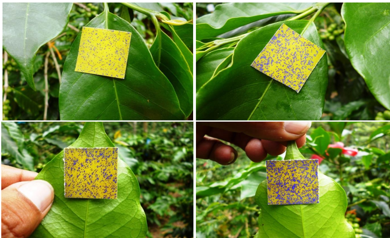
Figura 20: Papel hidro sensible marcado por las aspersiones en haz y envés (17/07/2015).
