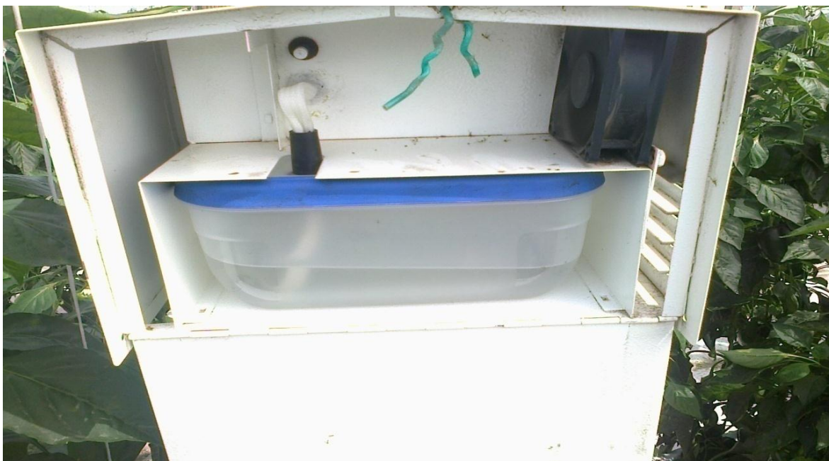
Foto 15. Caja de clima utilizada para la toma de datos de temperatura y humedad
