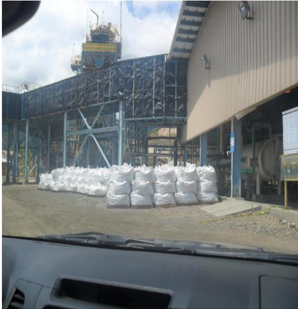
En esta fotografía se pueden observar que después de ser transportados los minerales, del tamaño de un pedrín son pasados seguidamente por otra trituradora o molino triturador, en este molino son depositadas bolas de acero las cuales son las que se pueden apreciar en los sacos blancos, esto con el objeto de que el mineral salga lo más fino posible.
