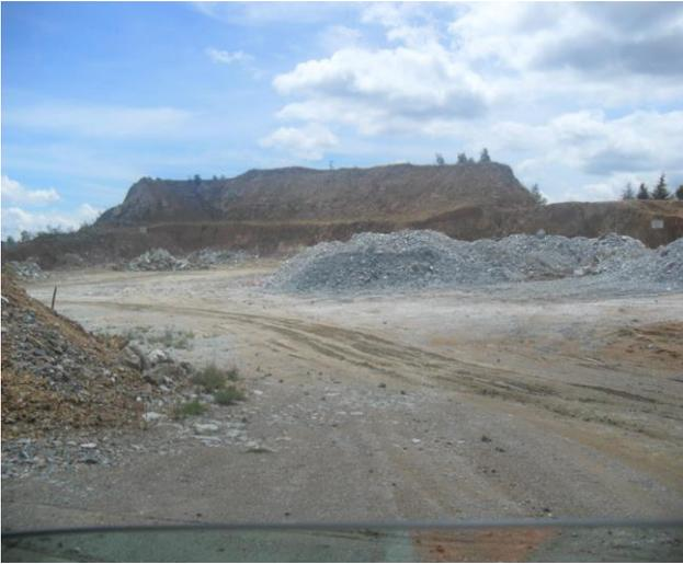
En esta fotografía se pueden apreciar los minerales ya triturados, a lo lejos se puede observar que hay rótulos, en cada sector depositan los minerales clasificándolos según su clase y calidad, los cuales seguidamente son transportados para continuar con el proceso.
