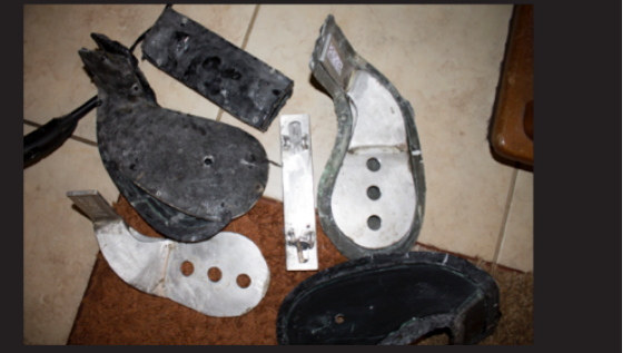
Imagen 20- Moldes de fibra de vidrio - Elaboración de prototipo conceptual Fuente: Propia
