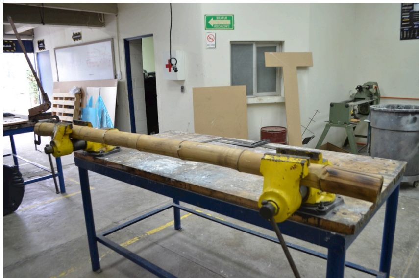
Imagen 115. Vara de bambú colocada y asegurada al banco de trabajo. Fuente: propia.
