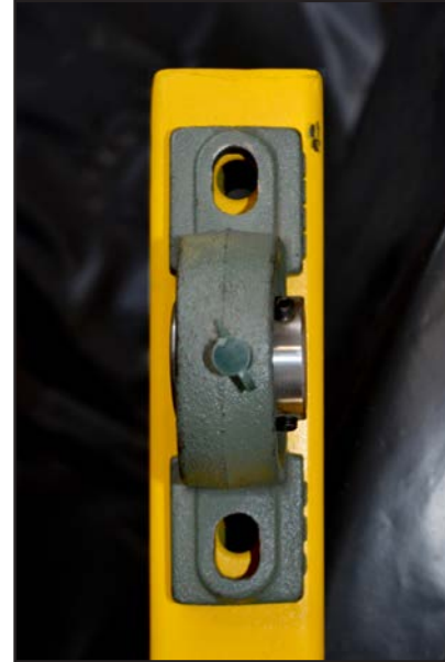
Imagen 226. Encajado de chumacera de banco y esta ya colocada. Fuente: propia
