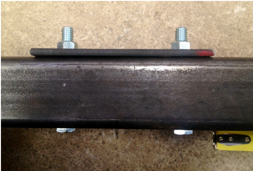
Imagen 212. Comprobación de encajado de perforaciones de platinas y tubos. Fuente: propia
