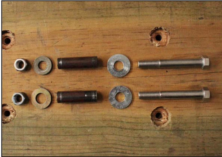
Imagen 234. Secuencia de colocado de tornillos de la base ajustable que sujetan las chumaceras. Fuente: propia
