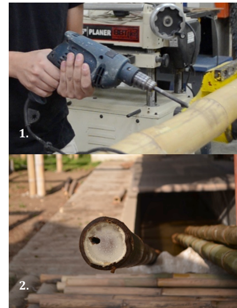
Imagen 38. 1- Perforación con taladro 2-Perforación de anillos centrales. Fuente: propia
