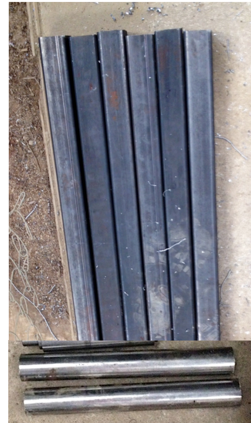
Imagen 210. Tubos y ejes ya cortados. Fuente: propia
