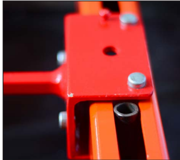
Imagen 239. Secuencia de colocado de tornillos de la base ajustable que sujetan las chumaceras. Fuente: propia
