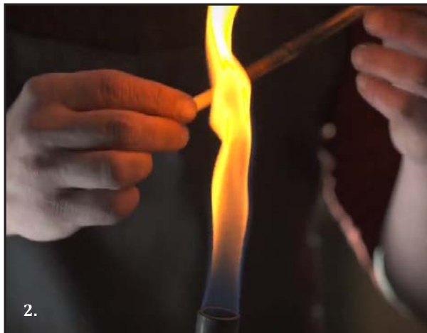
Imagen 82. 1-2 Hombre quemando bambú manualmente en el taller de Gucci utilizando un quemador de gas sujeto a la mesa. Fuente: https://www.youtube.com/watch?v=Z5M2iTE-s8E Fecha de recuperación: 1/03/2014
