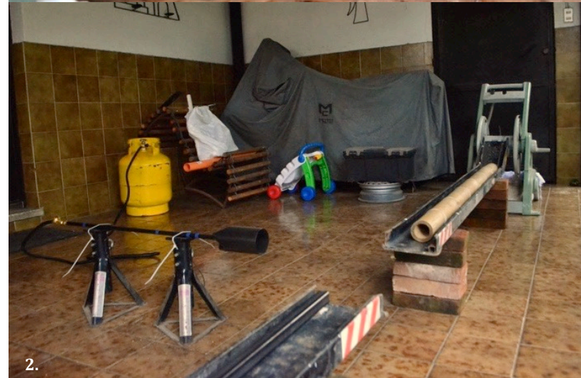
Imagen 129. 1- Sistema de apoyo y alineado completo. 2- Segundo riel metálico que conforma el sistema. Fuente: propia.
