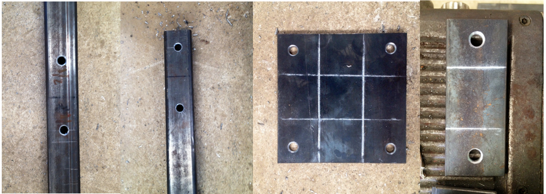
Imagen 211. Tubos y ambos tipos de platinas perforados. Fuente: propia
