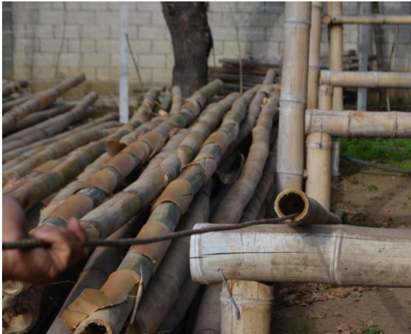
Imagen 54. Perforación de anillos internos. Fuente: propia
