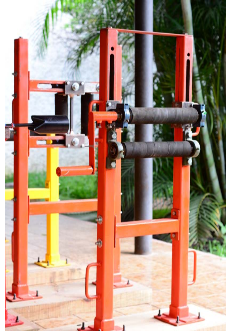
Imagen 223. Ejes con recubrimiento de hule colocado. Fuente: propia
