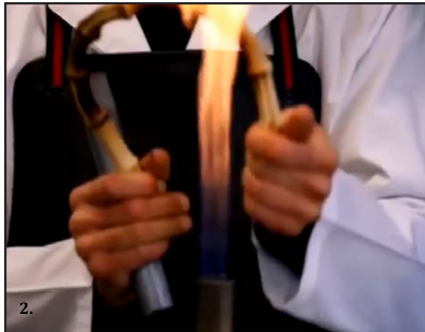
Imagen 81. 1-2 Hombre quemando bambú manualmente en el taller de Gucci utilizando un soplete de gas sujetado con un banco. Fuente: https://www.youtube.com/watch?v=2NbhkdjiWj0 Fecha de recuperación: 1/03/2014
