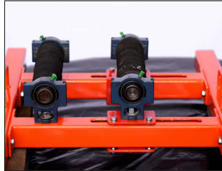
Imagen 235. Secuencia de colocado de ambos ejes ya con chumaceras y detalle de base ajustable con resorte colocado. Fuente: propia
