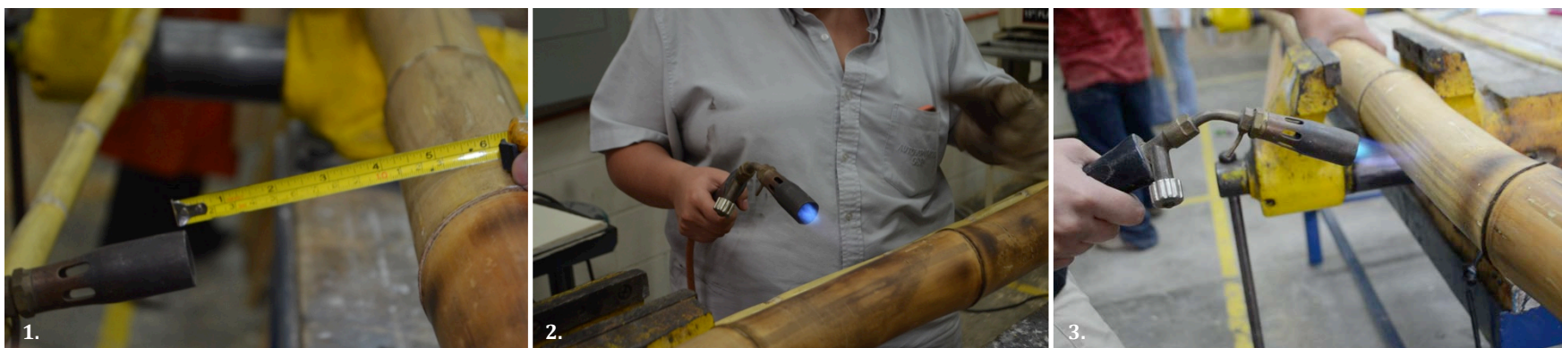
Imagen 120. 1- Medida de distancia entre el soplete y la vara de bambú 2- Quemado de vara de bambú, frontal. 3- Quemado de vara de bambú, lateral. Fuente: propia.
