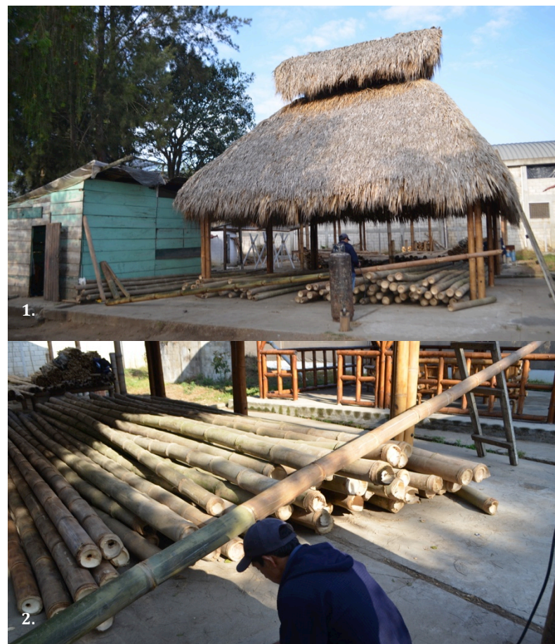
Imagen 62. 1- Rancho donde se aplica el quemado. 2- Forma en la que se apoya la vara para su quemado. Fuente: propia
