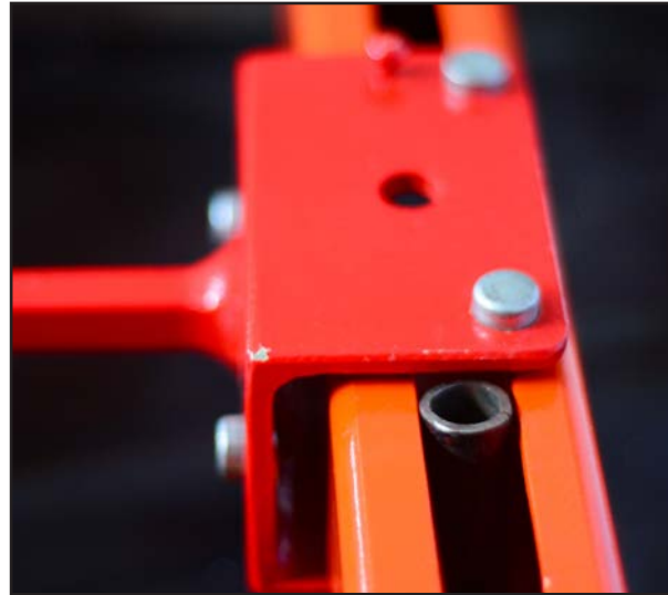
Imagen 234. Secuencia de colocado de tornillos de la base ajustable que sujetan las chumaceras. Fuente: propia
