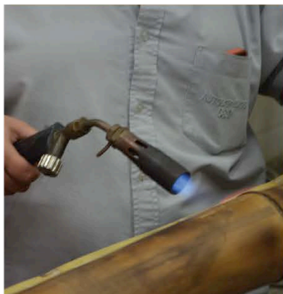
Imagen 95. Quemado de bambú con soplete de gas propano. Fuente: propia
