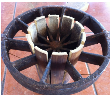
Imagen 28. Corte de bambú con cuchilla de estrella. Fuente: Oscar Quan
