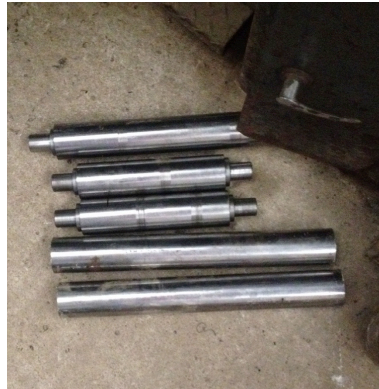
Imagen 221. Ejes torneados y ejes sin toronar. Fuente: propia
