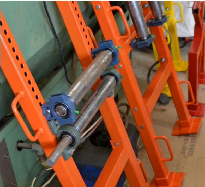
Imagen 222. Ejes sin recubrimiento de hule colocado. Fuente: propia
