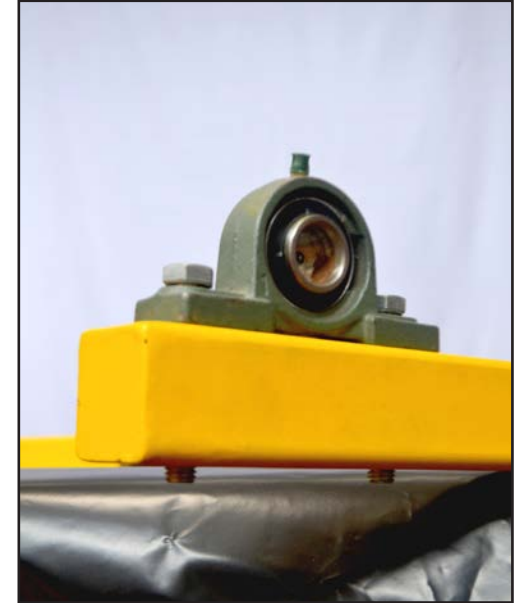
Imagen 226. Encajado de chumacera de banco y esta ya colocada. Fuente: propia
