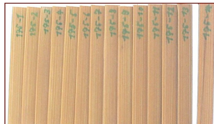
Imagen 43. Resultados de segunda prueba de horneado. Fuente: Bamboo in the laboratory, Wolfram Schott
