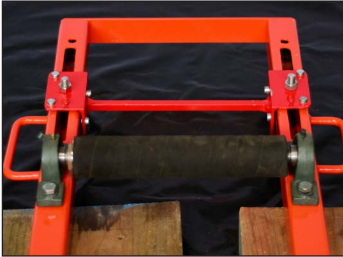
Imagen 240. Secuencia de colocado de chumaceras de banco y eje superior. Fuente: propia
