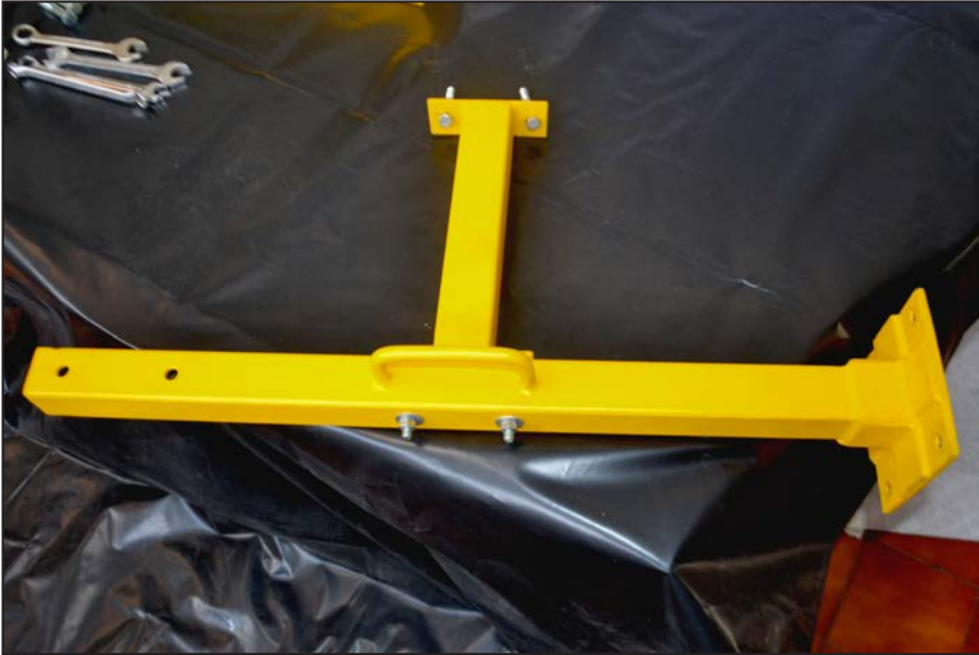
Imagen 225. Poste con estabilizador colocado. Fuente: propia
