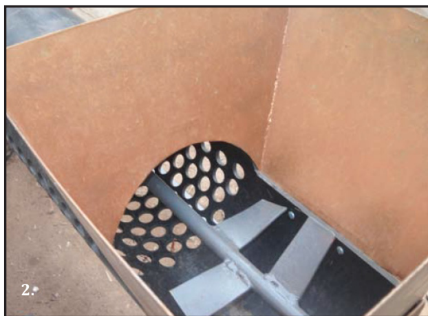
Imagen 84. 1-2 Descobajadora de uva, fabricada por Juan Coronel. Fuente: Máquinas y herramientas para la agricultura familiar, INTA (2,011)
