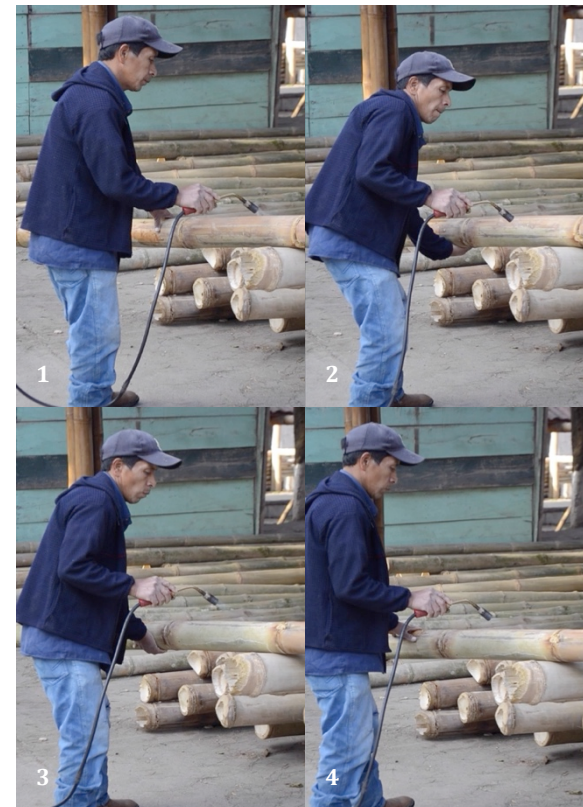
Imagen 64. Secuencia de rotado de caña de bambú. Fuente: propia.
