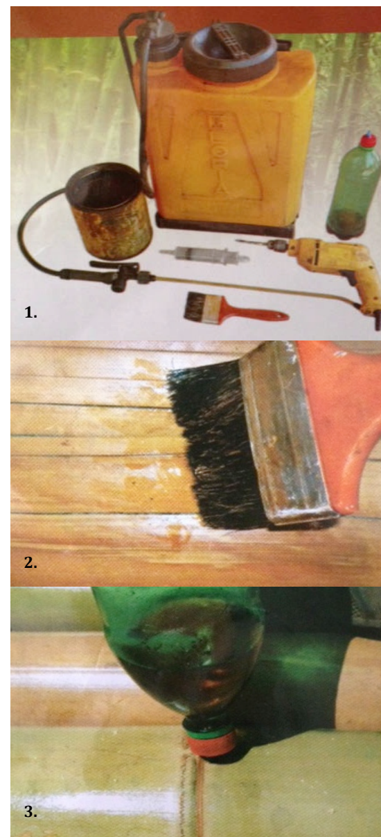
Imagen 36. 1- Herramientas para aplicación de diesel 2- Aplicación con brocha 3- Aplicación con botella plástica. Fuente: Tratamiento de material con diesel para la construcción con bambú , Misión Técnica de Taiwan en Guatemala.
