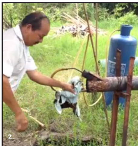
Imagen 78. 1-2 Hombre quemando bambú utilizando un quemador improvisado. Fuente: https://www.youtube.com/watch?v=DDF8y6jw6xl Fecha de recuperación: 1/03/2014
