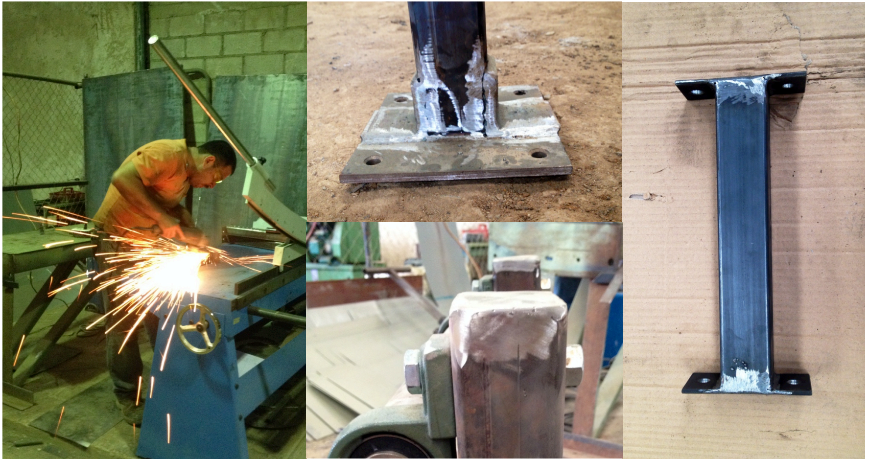
Imagen 216. Pulido de asperezas y puntos de unión. Fuente: propia
