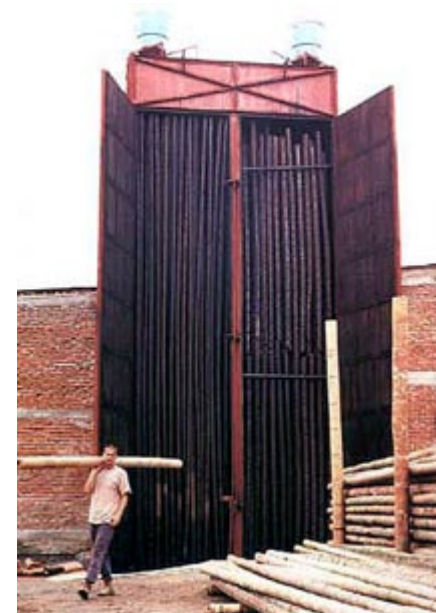
Imagen 33. Horno para ahumar bambú. Fuente: http://www.conbam.info/pagesES/basics.html . Fecha de recuperación: 21/01/2014
