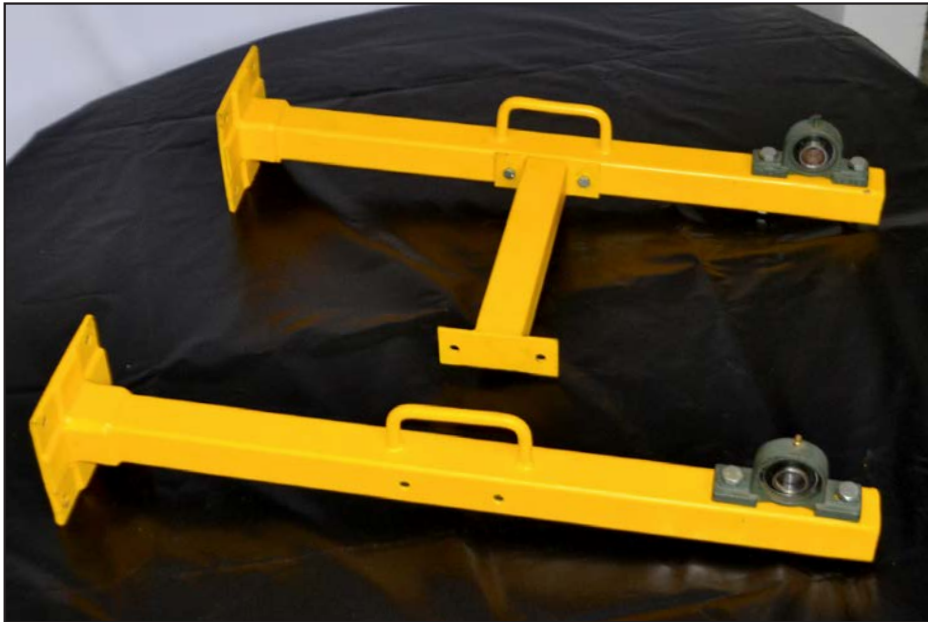
Imagen 229. Ambos postes con chumaceras colocadas. Fuente: propia
