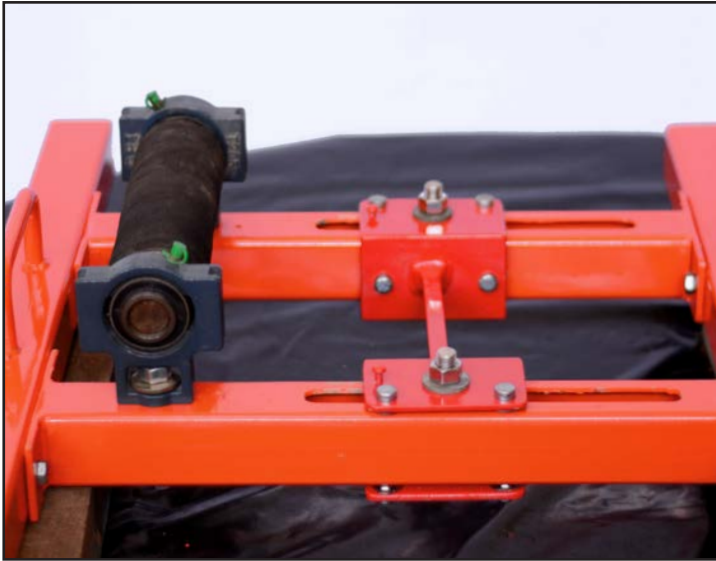
Imagen 235. Secuencia de colocado de ambos ejes ya con chumaceras y detalle de base ajustable con resorte colocado. Fuente: propia
