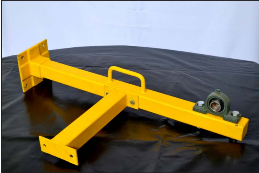
Imagen 227. Poste con estabilizador y chumacera colocada. Fuente: propia
