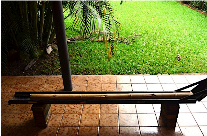
Imagen 128. Riel metálico apoyado sobre ladrillos y bambú de vara colocado en su punto de partida. Fuente: propia.
