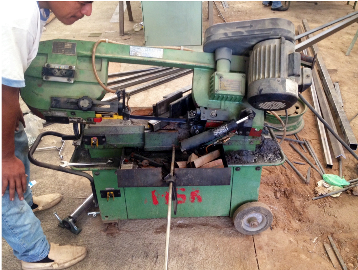
Imagen 209. Corte de piezas con sierra de cinta hidráulica. Fuente: propia
