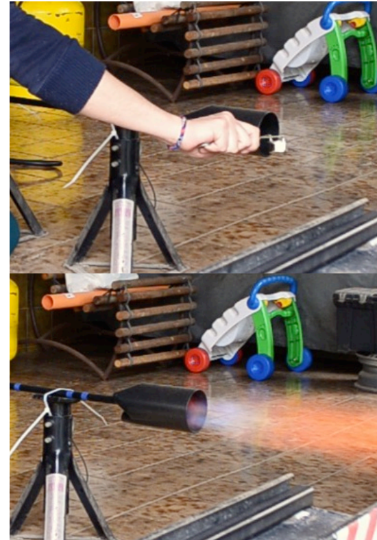
Imagen 133. Secuencia de encendido de antorcha. Fuente: propia.
