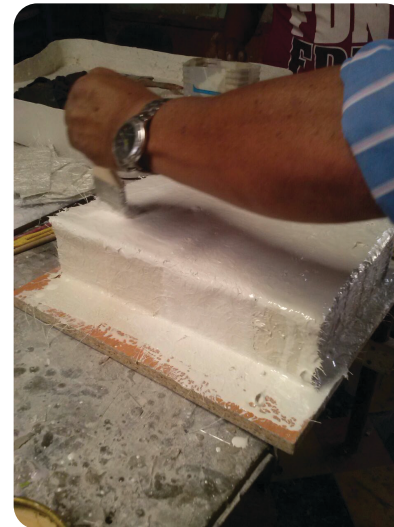
4. Se mezcla la fibra de vidrio con resina. Se empieza a colocar sobre el molde.
