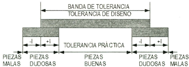
Figura 12. Reducción de la Tolerancia de diseño debida a la incertidumbre del instrumento de medida utilizado.
