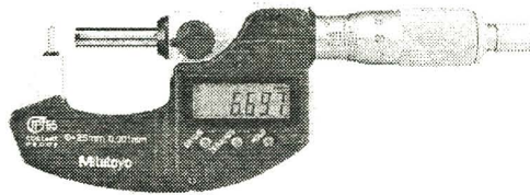
Figura 41. Micrómetro para paredes de tubos. (Mitutoyo)
