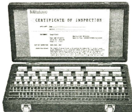
Figura 2. Juego de bloques patrón de 112 bloques. (Mitutoyo).
