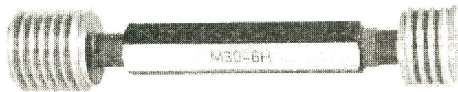
Figura 76. Calibre tampón para agujeros roscados.
