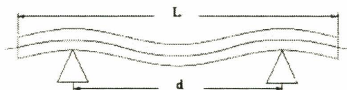
Figura 8. Representación de un bloque patrón largo, la distancia de los puntos de apoyo viene determinada por los puntos de Airy.
