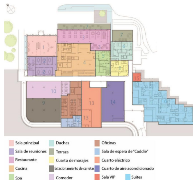
Planta del segundo nivel Fuente: http://www.plataformaarquitectura.cl/cl/02-349434/club-de-campo-nueve-puentesshigeru-ban-architects
