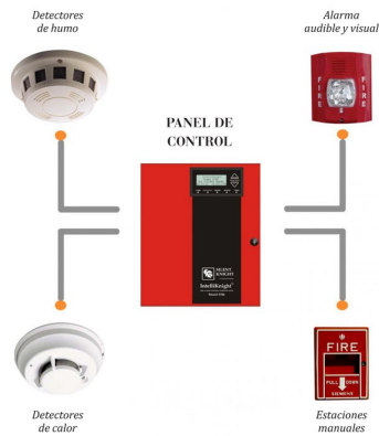
Imagen 36. Sistema de detección y alarma
