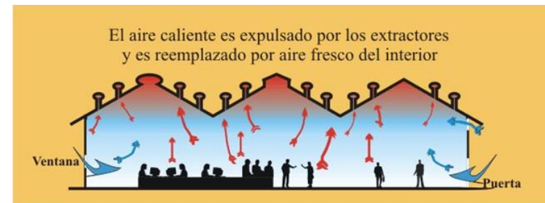
Imagen 39. Sistema para la ventilación de humo y calor
