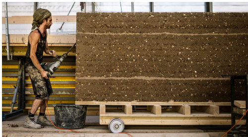
Elaboración de segmentos de tapial. Foto por: Ricola
