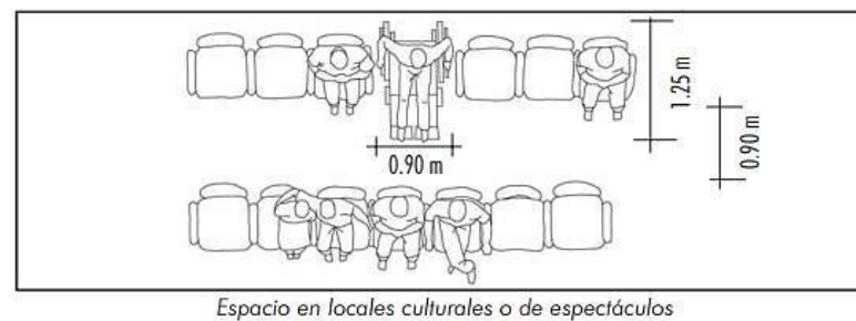
Imagen No.83: Dimensiones mínimas para una silla de ruedas en un espacio cultural o de espectáculos. Fuente: http://www.peruaccessible.com/discapacidadydisenoaccessible_versionpdf.pdf
