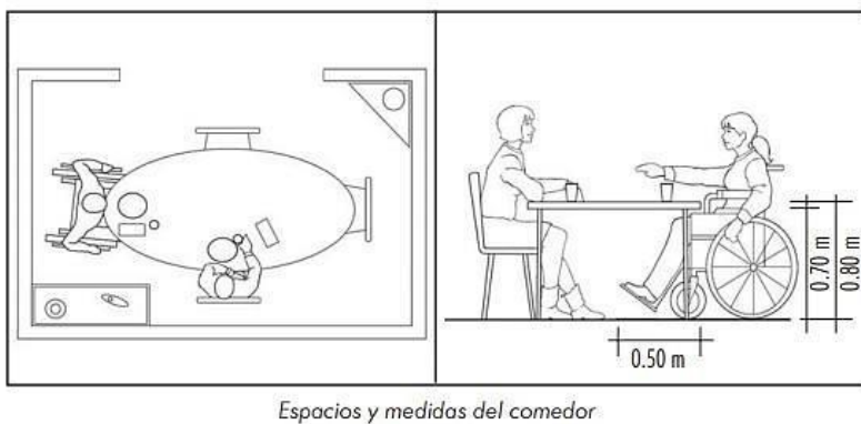
Imagen No.82: Dimensiones de altura de una silla de ruedas. Fuente: http://www.peruaccessible.com/discapacidadydisenoaccessible_versionpdf.pdf
