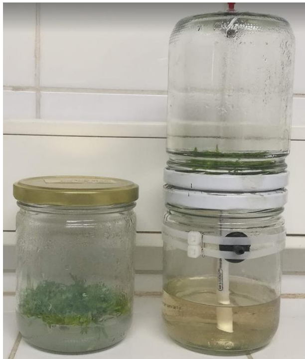
Ilustración 18. Diferencia visual entre unidad de cultivo de método tradicional (izquierdo) Respecto al biorreactor diseñado (derecho). Fuente: elaboración propia (2018)
