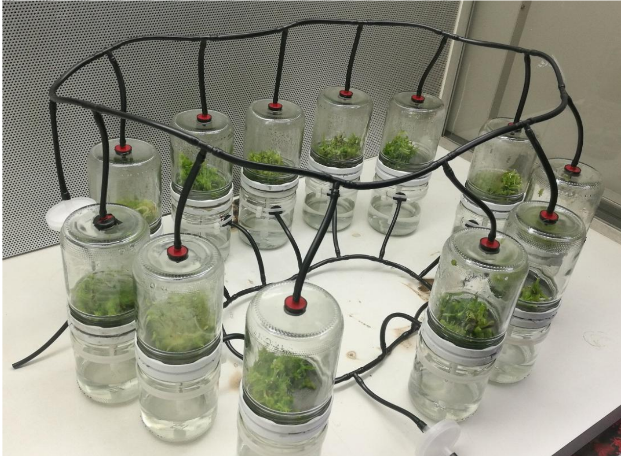
Ilustración 12. Sistema de biorreactores de inmersión temporal. Fuente: elaboración propia (2018)
